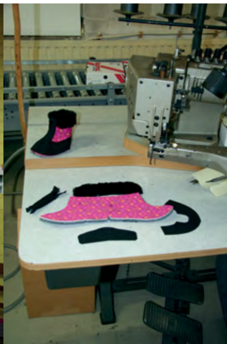
4. Alla delar som ska sys och som behövs för skon samlas ihop.
