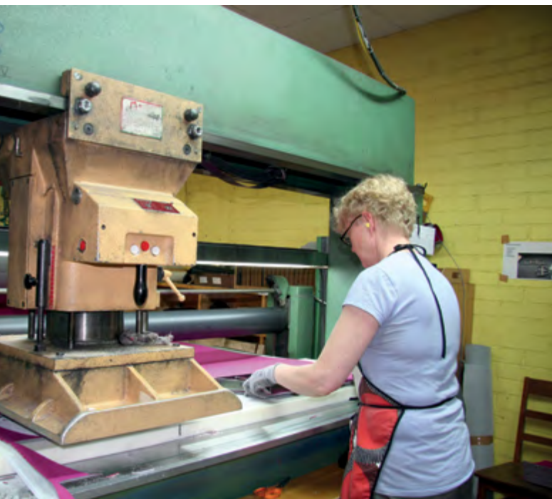
3. En automatisk körnare klipper ut överdelarna för stöveln av tyget enligt mönstret.
